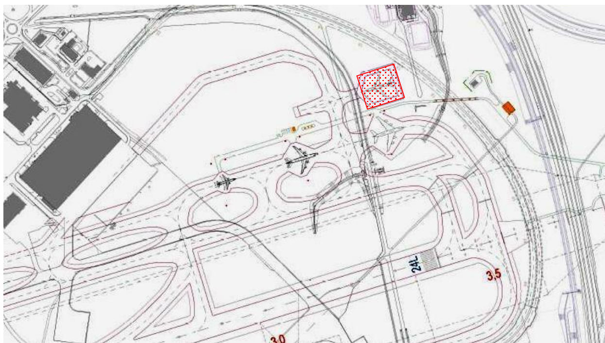
Obr. 9 Nové motorové stání v systému letištních komunikací a provozních ploch LKPR (podle projektové dokumentace Nikodem a Partner)
